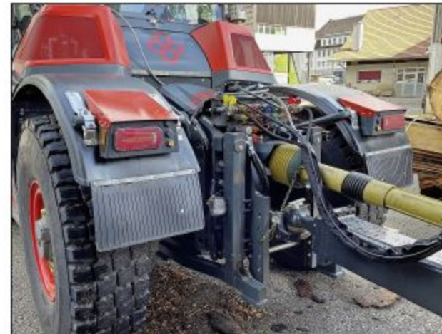
Der Syntrac kann auf Knopfdruck den gesamten Anbaubereich als Ganzes innert Sekunden abkoppeln und wieder anstecken.
