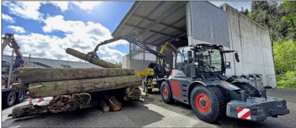
Der CAT-Motor mit 420 PS stemmt bei 1400 Motorumdrehungen 1900 Nm auf die Kurbelwelle.
