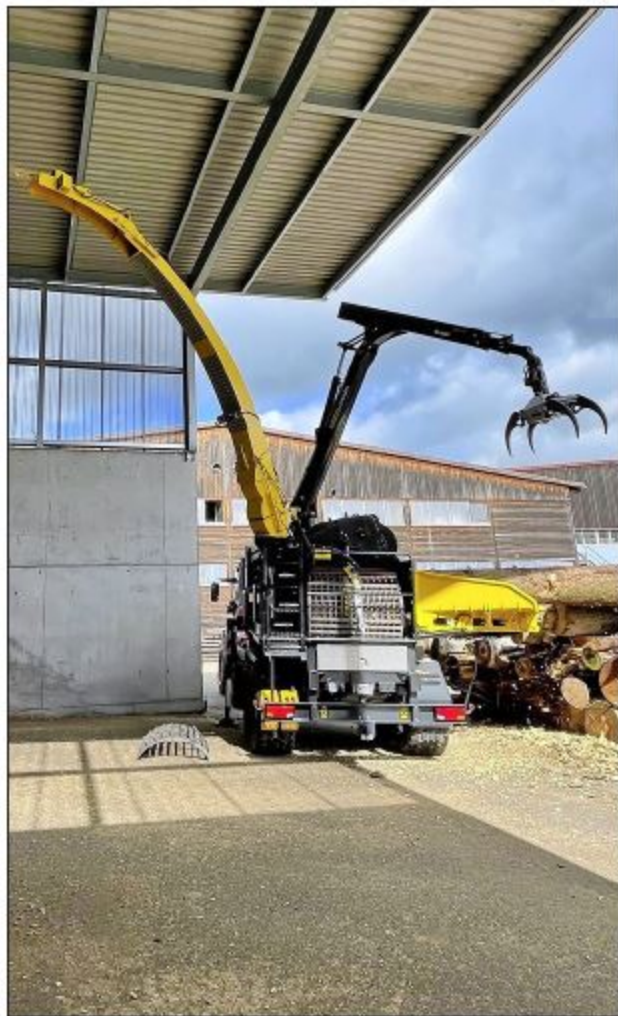
Bis zu 280 Schüttraummeter Hackguterzeugung sind mit der neuen Zapfwellenmaschine möglich. (Bild: Daniel Hasler)
